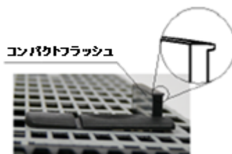
図 3-2: CF カードの挿入(上面:CF カードスロット)
