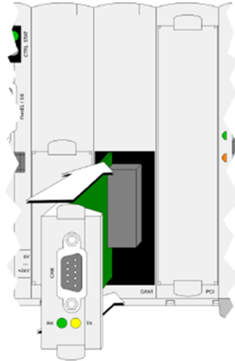
図.5-2: プラグインモジュールのロットへの装着
